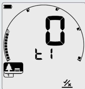
Schermata di regolazione Break Tono che mostra il punto finale predefinito Break Tono per t1: 0.
